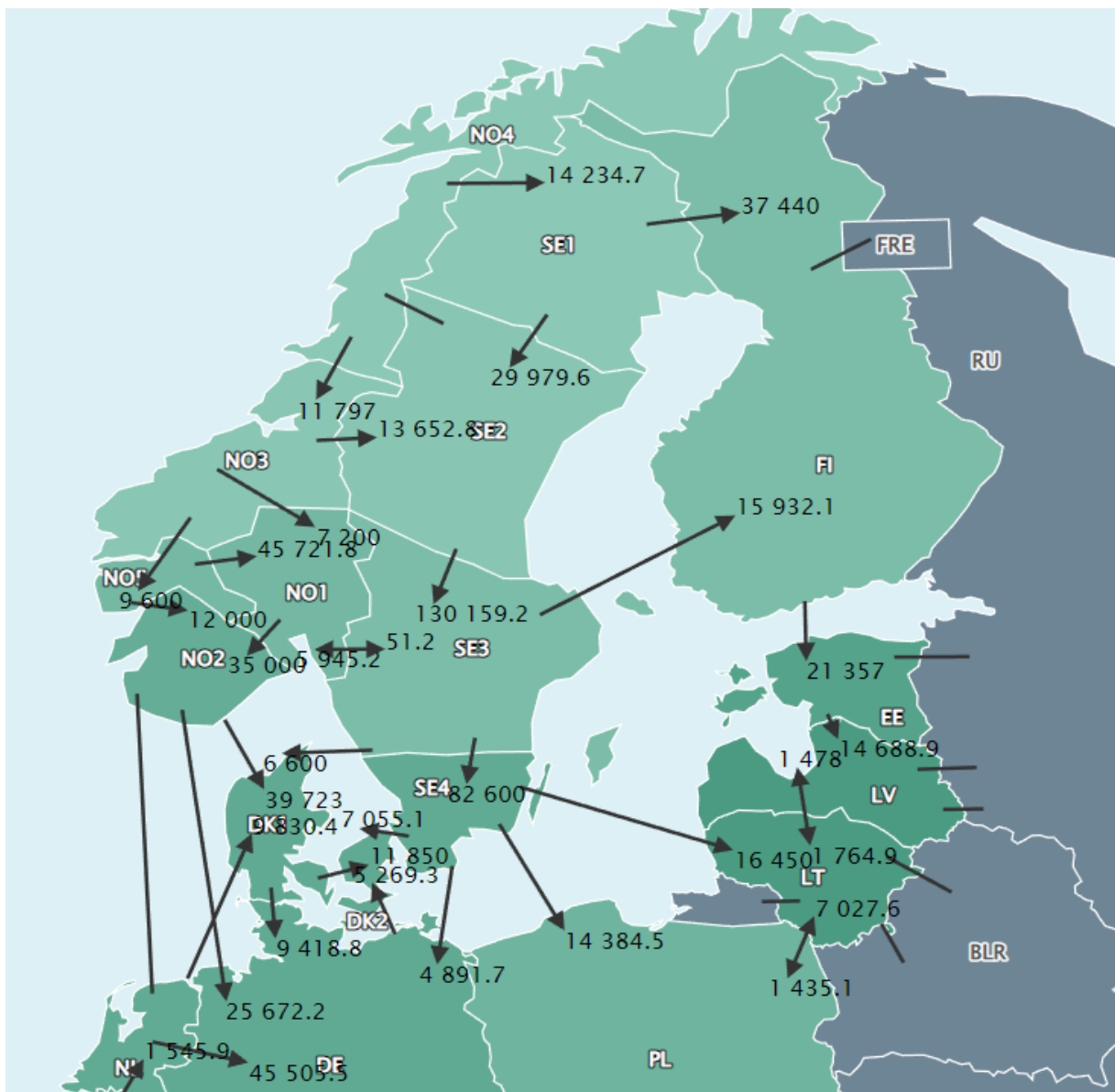
Joonis 10. Ülekandevõimsuste maht (MW) ja elektri voo suund 17.08.2022 (Nord Pool)
